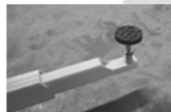
Soporte de elevación roscada de dos etapas
